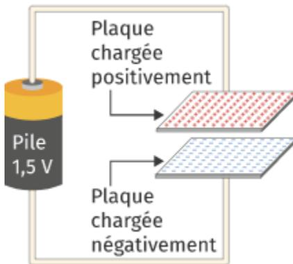
Le condensateur est un dipôle constitué de deux armatures parallèles en vis-à-vis séparées par un isolant appelé diélectrique. Il peut avoir une accumulation de charges sur les armatures lorsque le condensateur est soumis à une tension électrique. L'une des plaques se charge positivement, l'autre négativement : on dit que le condensateur se charge. Cette charge dépend de sa capacité  $C$ .
